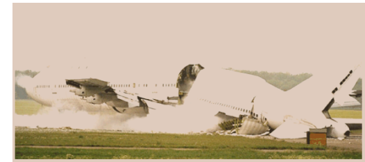
Tests d'explosions d'un B 747 avec 200 gr de Semtex à 30 000 pieds (9PSI)
