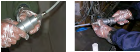
L'aspiration des molécules volatiles à l'aide d'un compresseur inversé
