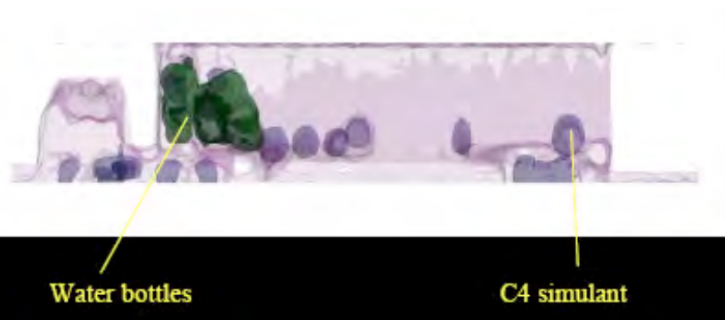
neutron radiographie d'un camion
